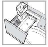
Esta função é útil para eliminar as manchas mais resistentes. Colocar o recipiente adicional 4, fornecido com o produto, no recipiente 1. Quando deitar a lixívia, não ultrapasse o nível "máx" indicado no pino central (veja a figura). Para efectuar somente o branqueamento
